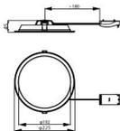
Caractéristiques Philips Downlight LED Ledinaire DN065B Métal Blanc 19W 2000lm 110D - 830-840-865 CCT | 225mm - Diamètre 200mm - IP20
