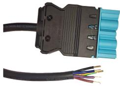
Caractéristiques Noxion GST - Compatible Câble d'alimentation Noir - Mâle + Extrémités ouvertes - 2m - 5 pole 1,5mm2
