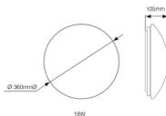
**Caractéristiques Noxion Hublot LED Corido Blanc 18W 1386lm - 830 Blanc Chaud | 360mm - IP44 - Détecteur de mouvement et de lumière**
