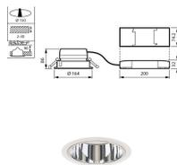
Caractéristiques Philips Downlight LED LuxSpace Mini profond DN561B 9W 1350lm 75D - 840 Blanc Froid | 164mm - Aluminium Réflecteur
