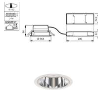
Caractéristiques Philips Downlight LED LuxSpace Mini profond DN561B VLC-E 7W 840lm 75D - 830 Blanc Chaud | 164mm - Aluminium Réflecteur - Dali Dimmable
