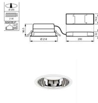
Caractéristiques Philips Downlight LED LuxSpace Compact bas DN570B VLC-E 16.5W 2200lm 80D - 830 Blanc Chaud | 214mm - Aluminium Réflecteur - Dali Dimmable
