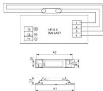
Caractéristiques Philips HF-S 154 TL5 II 50/60Hz
