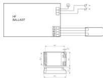
Caractéristiques Philips HF-P 1 22-42 PL-T/C/L/TL5C II 220-240V for 1x22-42W
