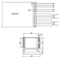
Caractéristiques Philips HF-R 2 26-42 PL-T/C EII 220-240V for 2x26-42W
