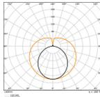
Caractéristiques Ledvance Tube LED T8 EM Superior Conventional (EM), Mains (AC) High Output T8 9.7W 1530lm - 830 Blanc Chaud | 90cm - Équivalent 30W
