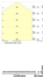
**Caractéristiques Ledvance Étanche Réglette Imperméable High Efficiency PC Gris 29W 4640lm - 840 Blanc Froid | 120cm - Dali Dimmable- Équivalent 2x36W**
