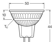
**Caractéristiques Ledvance Spot LED GU5.3 MR16 3.8W 350lm 36D - 830 Blanc Chaud | Équivalent 35W**
