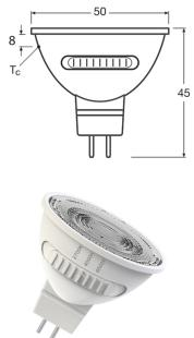
**Caractéristiques Osram LED Superstar Réflecteur Spot GU5.3 MR16 5.6W 550lm 45D - 827 Blanc Très Chaud | Équivalent 45W**
