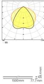
**Caractéristiques Ledvance LED Rail de fixation suspendu Trusys Flex Claire 70W 12100lm 90D - 840 Blanc Froid | Dali Dimmable**
