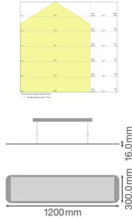
**Caractéristiques Ledvance Panneau LED Suspension luminaire 36W 4000lm - 840 Blanc Froid | 120x30cm - UGR <19 - Dali Dimmable**
