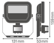
**Caractéristiques Ledvance Projecteur LED Sensor GEN 3 Blanc 10W 1100lm 100D - 830 Blanc Chaud | IP65 - Détecteur de mouvement et de lumière - Symétrique**
